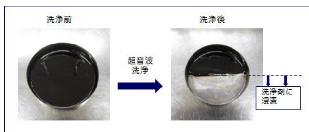
第6図 パインアルファST-350Uの洗浄結果
