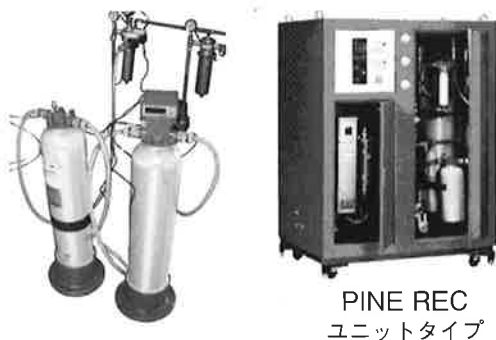
図5 純水再生装置例
